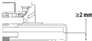
For alt tilbehør til slibning, afslibning med sandpapir og trådbørstning med hjul skal den nederste del af tilbehøret være anbragt inden for beskyttelseskabinetts med mindst 2 mm afstand til beskyttelseskabinetts nederste kant.
